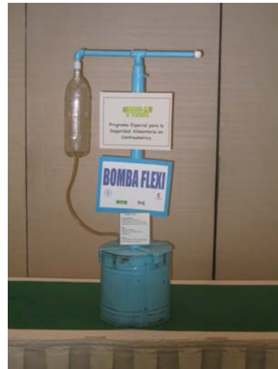
Bomba Flexi para extracción manual de agua en un pozo
