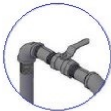
Détail A Vanne de passage et raccord de 3/4" écrou de 3/4" de canalisation
